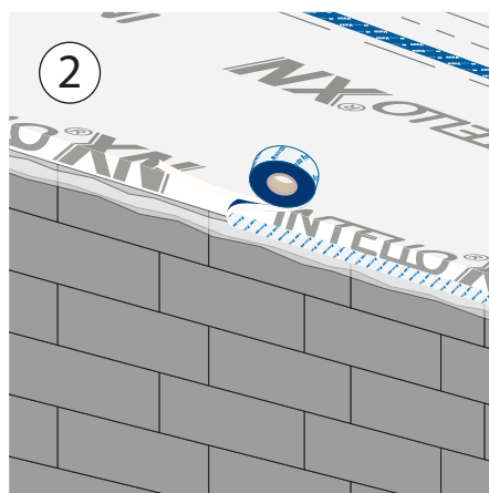
Liitosnauha kiinnitetään ensin yläpohjan höyrynsulkuun ja sitten seinään.
