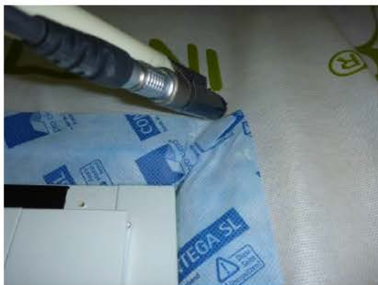
Kuvat 15, 16 ja 17. Merkittäviä vuotoja havaittiin nurkkaliitoksissa, joissa liitosnauhat oli laskostettu taittamalla nurkan muotoon.
