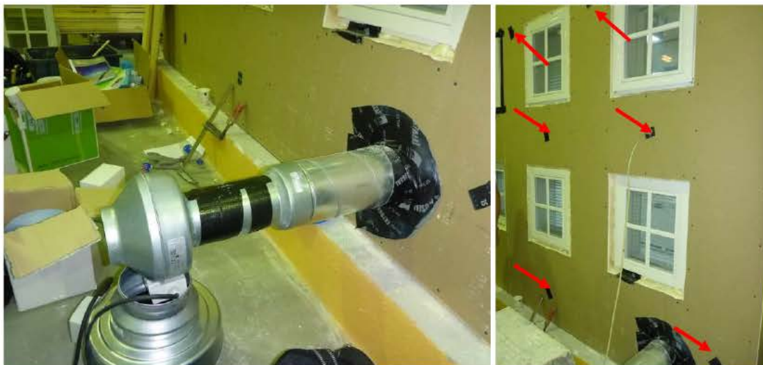
Kuvat 9 ja 10. Testijärjestely vasemmalla alipaineistukseen käytetty kanavapuhallin, oikealla merkkikaasun syöttöpisteitä ulkoseinärakenteessa.
